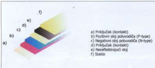
■ Slika 7. Fotonaponska ili fotovoltaična ćelija (photovoltaic – PV)
