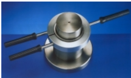
Slika 13. Zagrijavanje unutarnjeg prstena ležaja prstenom za grijanje
