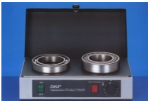
Slika 12. Zagrijavanje ležaja na ploči za grijanje
