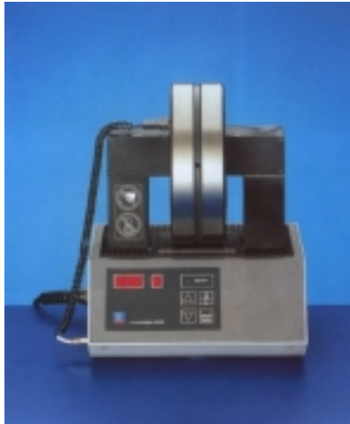
Slika 11. Zagrijavanje unutarnjeg prstena ležaja indukcijskom grijalicom
