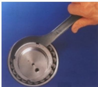
Slika 14. Ugradnja ležaja pritezanjem matice za osiguranje unutarnjeg prstena
